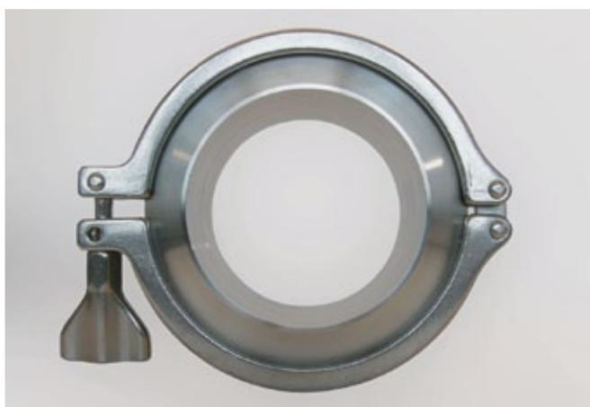
1. Längere Standzeiten für die Verbindungen durch den definierten Druck auf die Dichtung. Vorzeitige Rissbildungen und Versprödungen bleiben aus, da die Verschlussendstellung in der Blockverbindung die D-förmige Dichtung nur bis max. 20% verformt. Für gasförmige oder flüssige Medien in Hochvakuum- oder Druckprozessen ein wichtiges Sicherheitskriterium.
