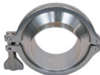
2. Geringere Materialermüdung durch die starre Block-Klemmverbindung. Druckstöße des Mediums, Temperaturschwankungen oder Spannungen im Rohrleitungssystem wirken sich weder auf die Dichtung noch auf die Stirnflächen aus, da der Blockschluss für eine permanent stabile Verbindung sorgt.
