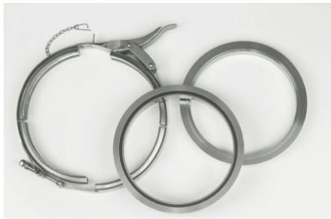
FLW Klemmverbindung als Spannband mit Schnellverschluss und Sicherung. Inkl. Spannvorrichtung am Gelenk sowie einmontierten Profissegmenten Separat: Nut- und Federflansch mit eingelegtem O-Ring.
