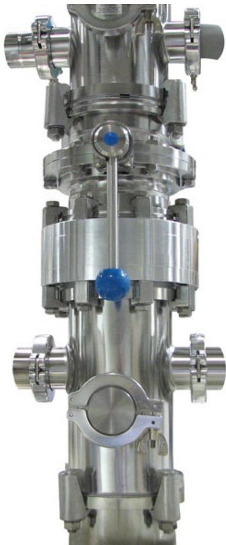
Der Bildausschnitt einer Vakuumpumpe zeigt von unten nach oben Klammerflansch mit Prätzen, Doppelgelenk-Schnellspannringe, Klammerflansch verschraubt, Scheibenventil, Klammerflansch mit Prätzen.
